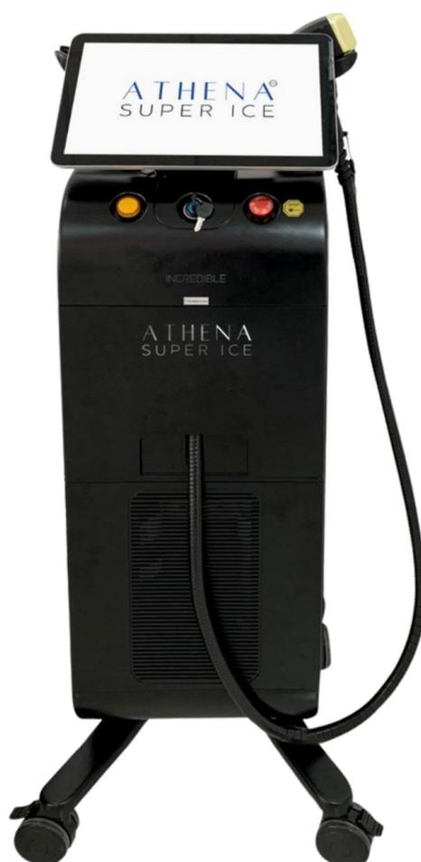
Au cours de l'installation, si vous devez soulever l'appareil, placez vos mains ou utilisez des outils appropriés sur les zones prévues à cet effet (telles que le bas de l'appareil ou le cadre de la roulette) comme points d'appui pour le transport. Veillez à ce que le produit soit correctement soutenu et ne l'inclinez pas de plus de 15° afin de maintenir sa stabilité.
